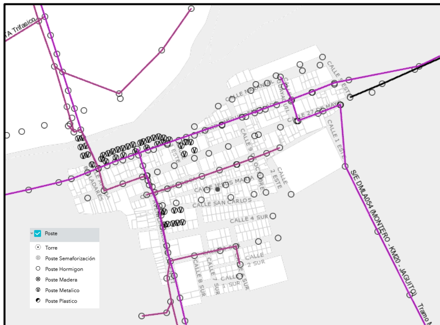
Gráfico 10 Tramos de tendido eléctrico y postes
